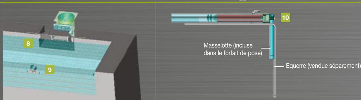
Ces découpes sont destinées aux bassins ayant des pièces à sceller coté axe. En effet, lorsque le tablier est fermé, il faut prévoir des découpes de skimmer ou de refoulement afin de permettre la circulation de l'eau.
