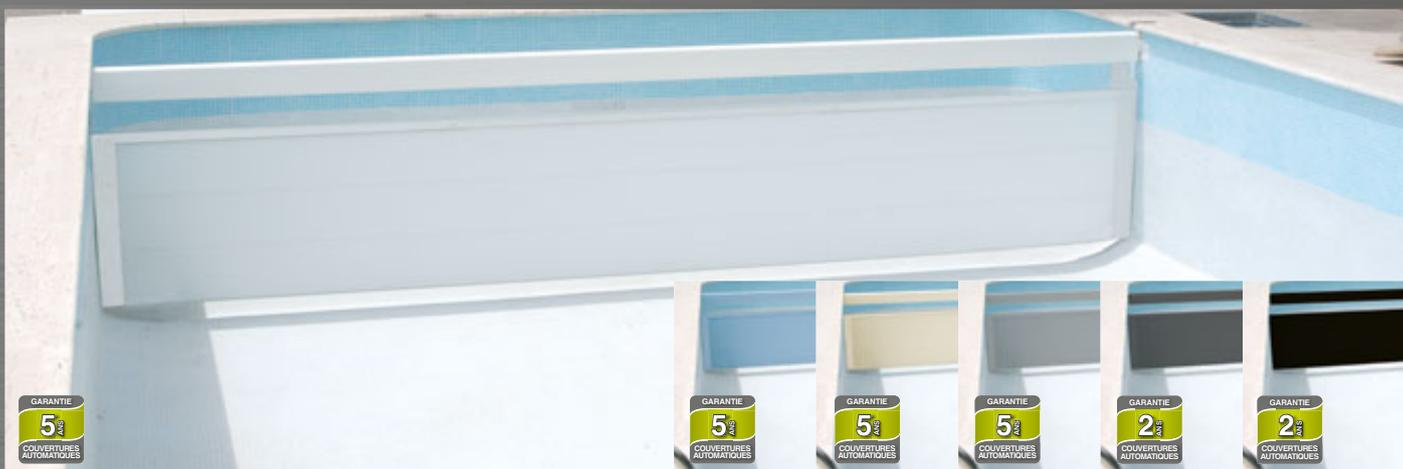
Spécialement conçues pour la mise en conformité des piscines avec la norme NF P 90-308. Chaque ensemble est fabriqué sur mesures, en usine. Compatible avec tous les types de revêtements (carrelage, liner, PVC armé...). Aucun percement de l'étanchéité de la piscine : La paroi Coverdeck est fixée sur une platine, scellée sous la margelle, de chaque côté de la piscine.
