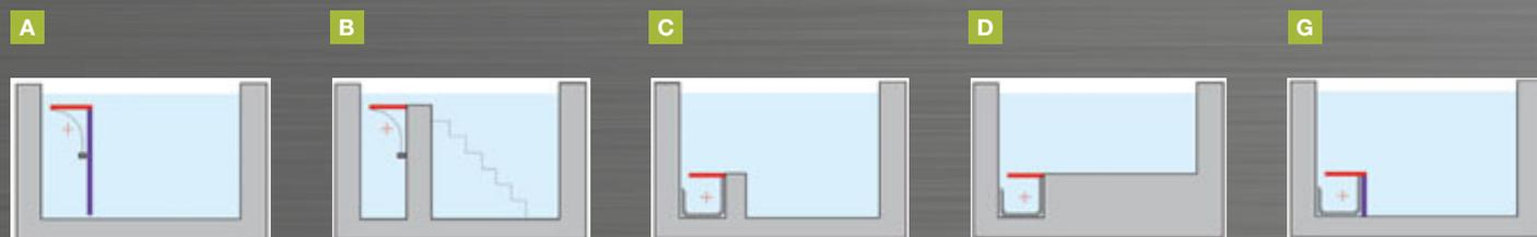
Dans les cas A et B, il n'est pas nécessaire de prévoir des accroches Delta Lock côté Axe si la distance entre le caillebotis et la surface de l'eau est inférieure à 200mm.
