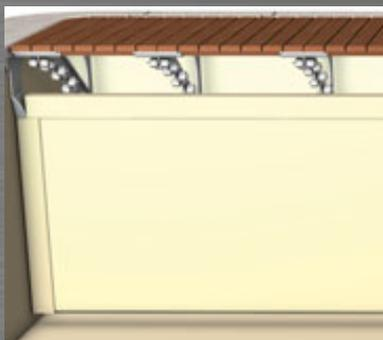
Spécialement conçues pour la mise en conformité des piscines avec la norme NF P 90-308. Chaque ensemble est fabriqué sur mesures, en usine. Compatible avec tous les types de revêtements (carrelage, liner, PVC armé...). Aucun percement de l'étanchéité de la piscine : La paroi Stardeck est fixée sur une platine, scellée sous la margelle, de chaque côté de la piscine.
