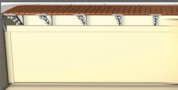
Spécialement conçues pour la mise en conformité des piscines avec la norme NF P 90-308. Chaque ensemble est fabriqué sur mesures, en usine. Compatible avec tous les types de revêtements (carrelage, liner, PVC armé...). Aucun percement de l'étanchéité de la piscine : La paroi Revodeck est fixée sur une platine, scellée sous la margelle, de chaque côté de la piscine.
